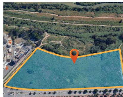
Para la ubicación de la instalación solar se ha seleccionado la parcela anexa a la EDAR. La configuración del campo solar se compone de 58 filas con 3 (o 4) captadores por fila inclinados 30° con un azimut de 27° y el espejo siguiendo el movimiento aparente del sol.
